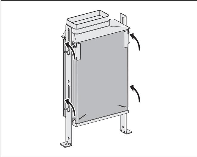
Die Höhe des Umluftfilters muss so eingestellt werden, dass ein vollständiges Aufklappen zur Entnahme der Filterpatrone jederzeit gewährleistet ist.
