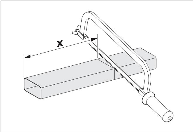
☞ Schneiden Sie passende Flachkanalstücke. Anzahl und Länge müssen zur Einbauvariante passen.
