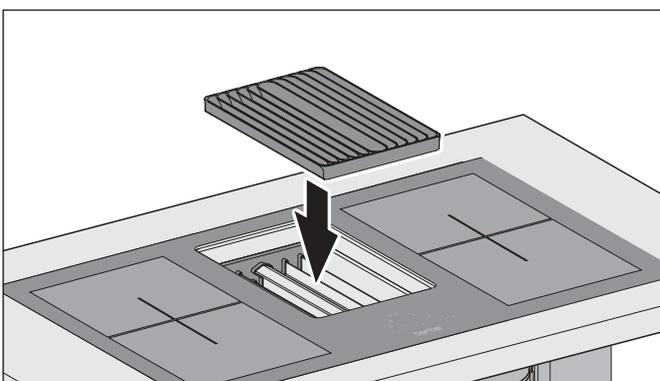
☞ Setzen Sie das Einströmgitter auf den Abscheideeinsatz.
