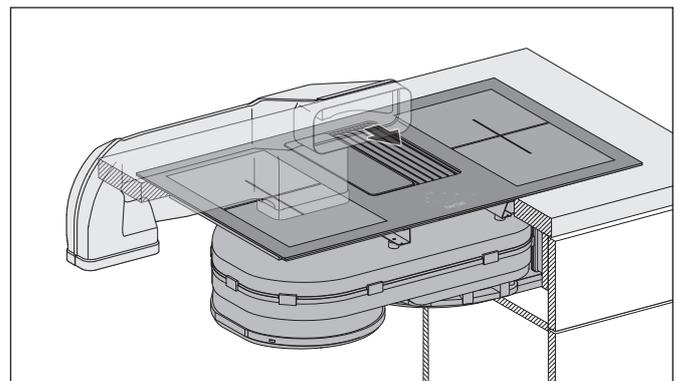
☞ Stecken Sie den Umluftbogen in den Anschluss am Lüftergehäuse.
