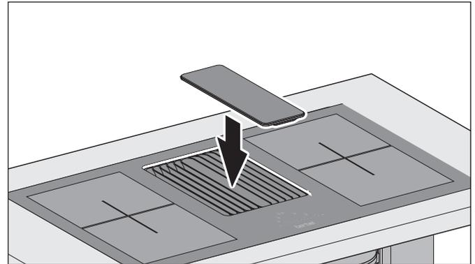
☞ Setzen Sie den Powermover auf das Einströmgitter.
